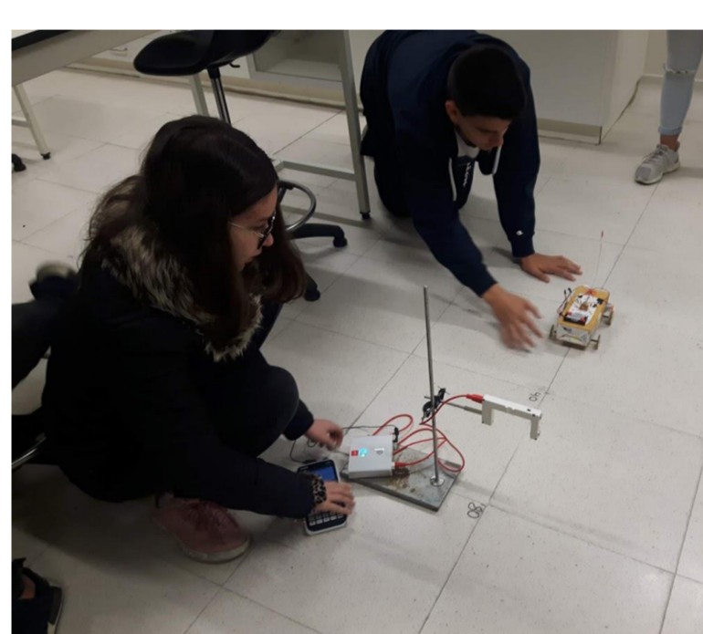
Figura 6. Utilização do CLAB para o estudo da relação entre a energia cinética e a distância percorrida por carros telecomandados.
